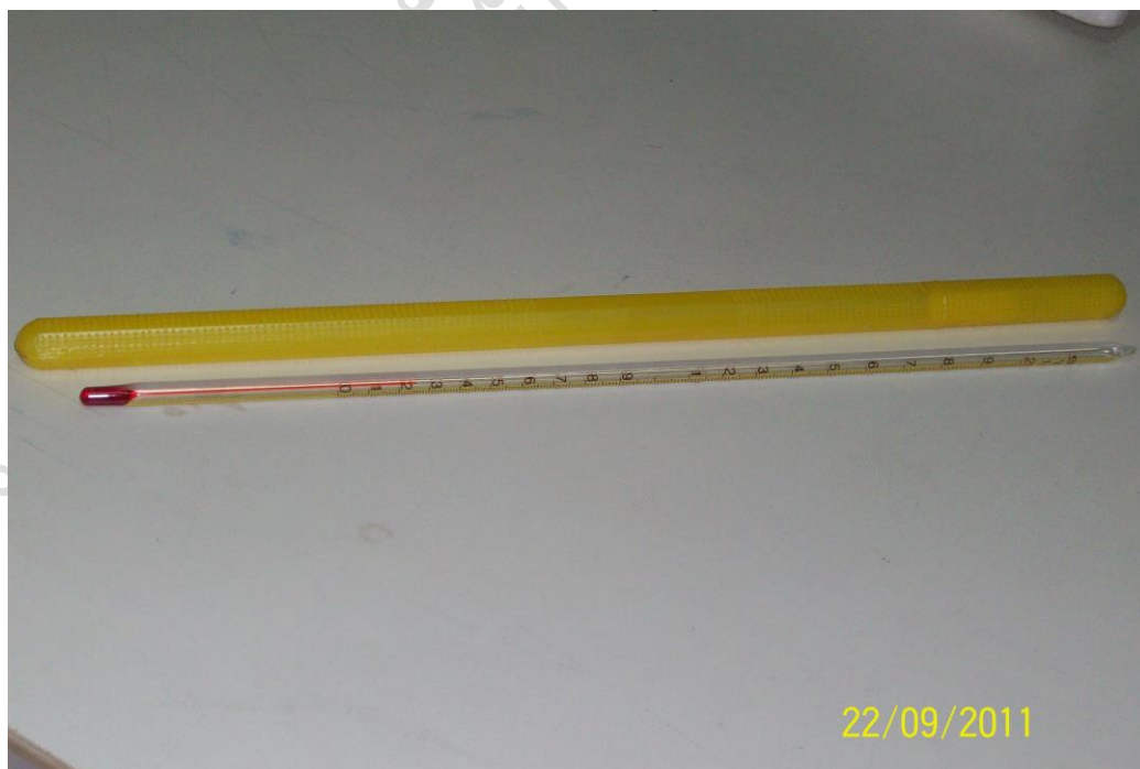
ภาพที่ ก-4 เทอร์โมมิเตอร์ ความละเอียด \pm 0.01 \text{ }^{\circ}\text{C}
