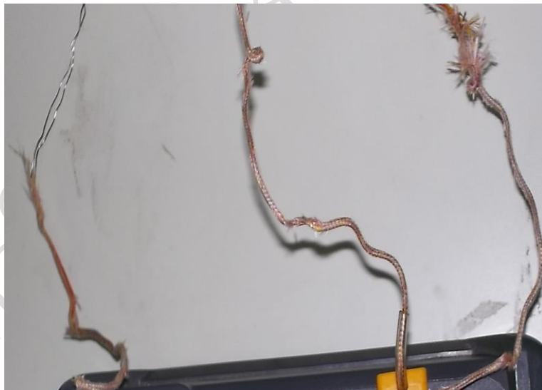
ภาพที่ ก-4 สายเทอร์โมคัปเปิล ชนิด เค (K-Type Thermocouple)
