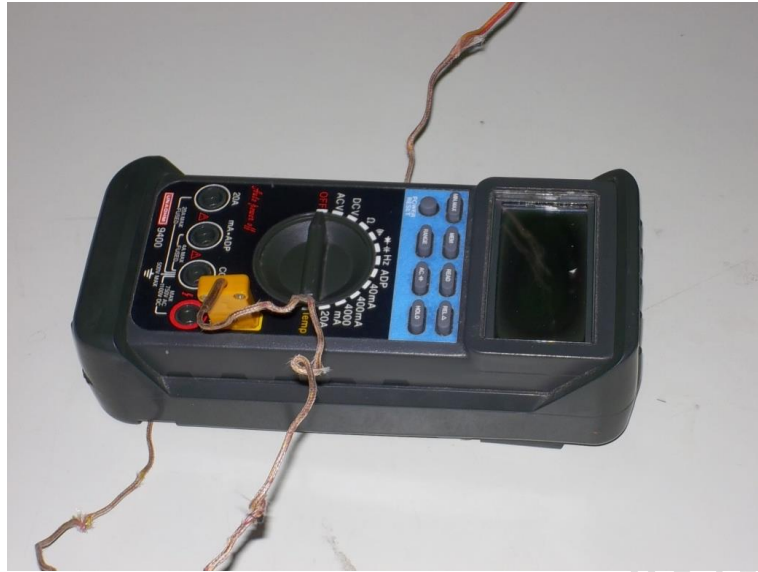
ภาพที่ ก-3 เครื่อง Digital Multimeter รุ่น UNA0HM 9400 ความละเอียด \pm 0.1\text{ }^{\circ}\text{C}
