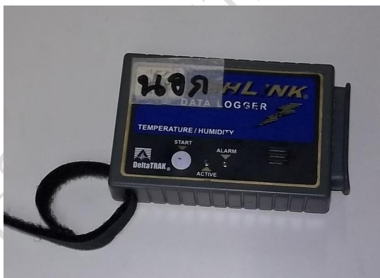
ภาพที่ ก-2 เครื่อง Flash Link Data Logger รุ่น Delta-TRAK ความละเอียด \pm 0.1 °C
