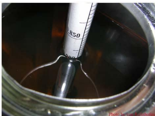
ภาพที่ 12 การวัดความถ่วงจำเพาะของเหลว
