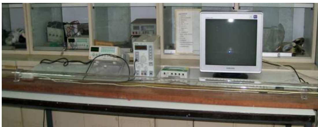
ภาพที่ 3.2 ชุดทดสอบสมบัติการดูดซับเสียง
