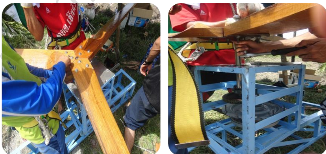
ภาพที่ 4.4 การประกอบใบพัดเข้ากับชุดมอเตอร์กำเนิดไฟฟ้า
