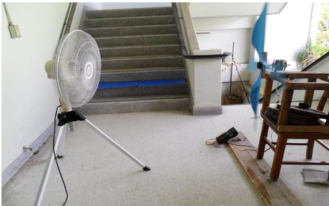
ภาพที่ ข-5 ทำการทดลองชุดทดลองกังหันลมผลิตกระแสไฟฟ้า
