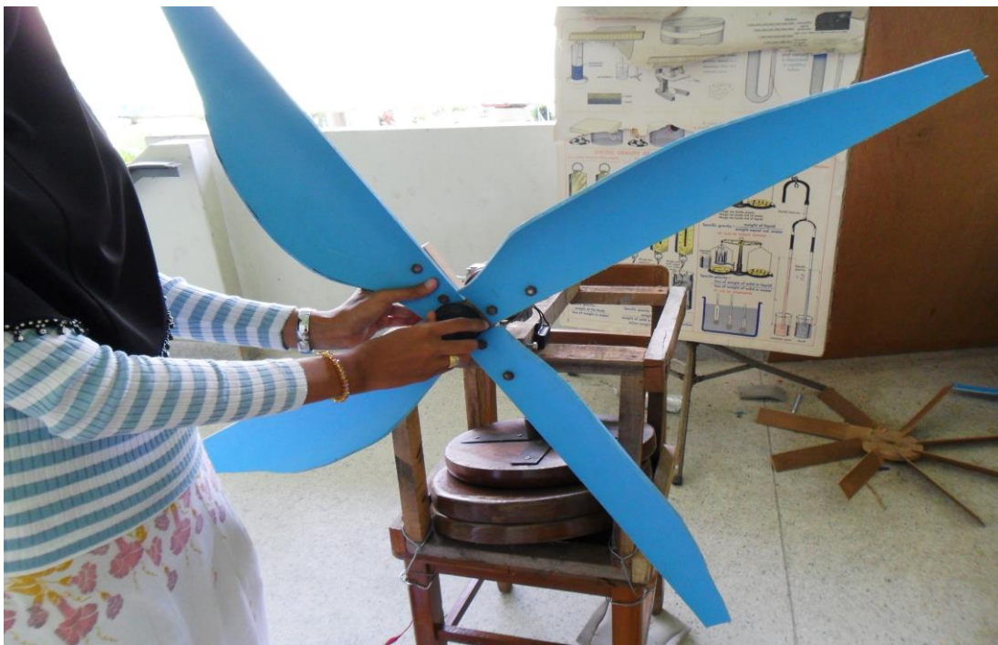
ภาพที่ ข-3 ประกอบใบพัดแต่ละชนิดเข้ากับมอเตอร์
