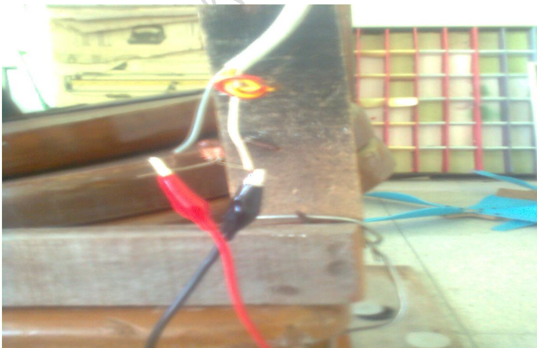
ภาพที่ ข-4 ประกอบหลอด LED เข้ากับสายไฟฟ้า
