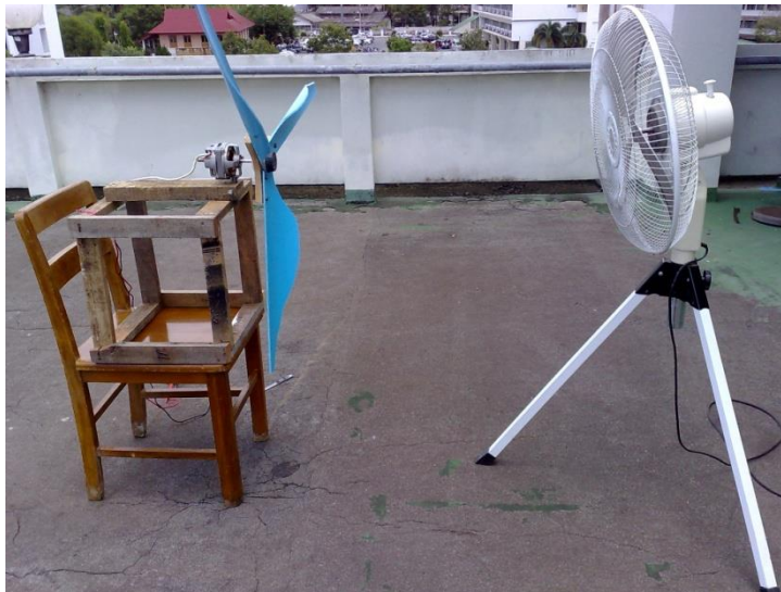
ภาพที่ 3.1 ส่วนประกอบของแบบจำลองกังหันลมผลิตไฟฟ้า
