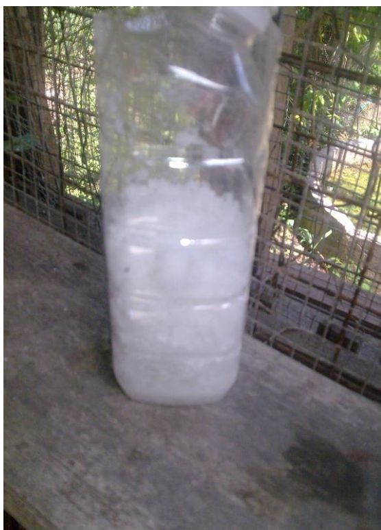
ภาพที่ ข-3 ปริมาณเกลือและน้ำที่ได้จากการกลั่นน้ำด้วยเครื่องกลั่นน้ำพลังงานแสงอาทิตย์
