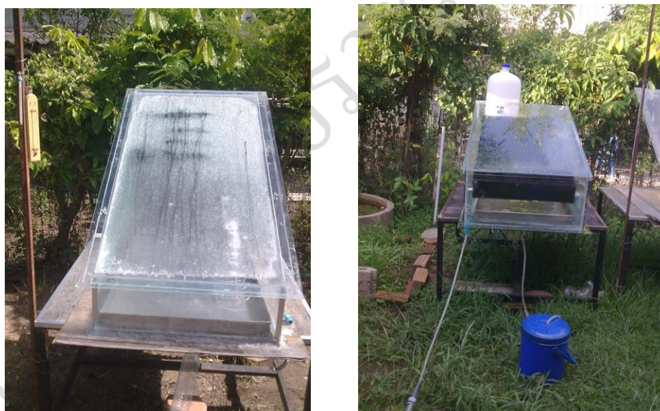
ภาพที่ 2.2 เครื่องกลั่นน้ำพลังงานแสงอาทิตย์แบบตู้เรียบฝาเอียงด้านเดียว
