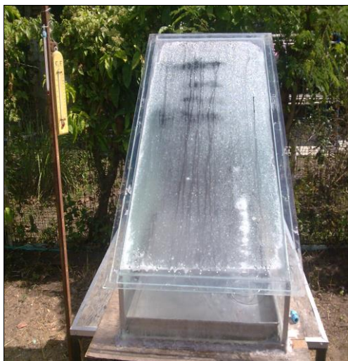
ภาพที่ ข-1 เครื่องกลั่นน้ำพลังงานแสงอาทิตย์แบบกระจกเอียงทำมุม 30 องศา พื้นที่รองรับคิบ 0.5 ตารางเมตร
