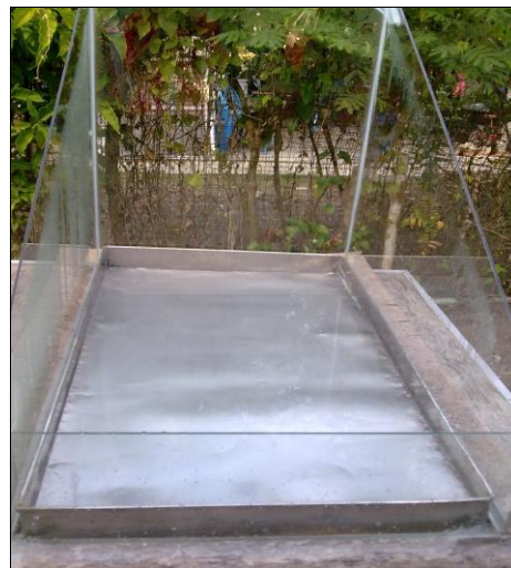
ภาพที่ ข-1 เครื่องกลั่นน้ำพลังงานแสงอาทิตย์แบบกระจกเอียงทำมุม 30 องศา พื้นที่รองรับคิบ 0.5 ตารางเมตร
