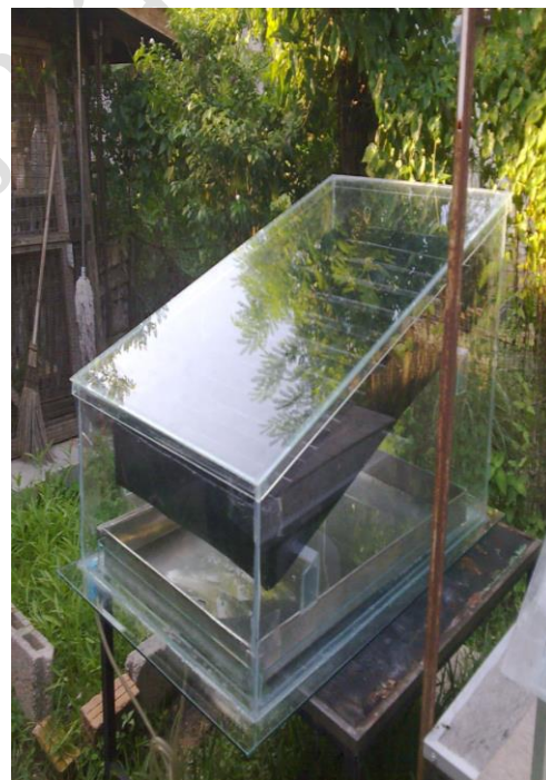
ภาพที่ ข-2 เครื่องทำอุ่นและน้ำกลั่นด้วยพลังงานแสงอาทิตย์แบบชั้นบันไดพื้นที่รองรับน้ำคิบ 0.89 ตารางเมตร
