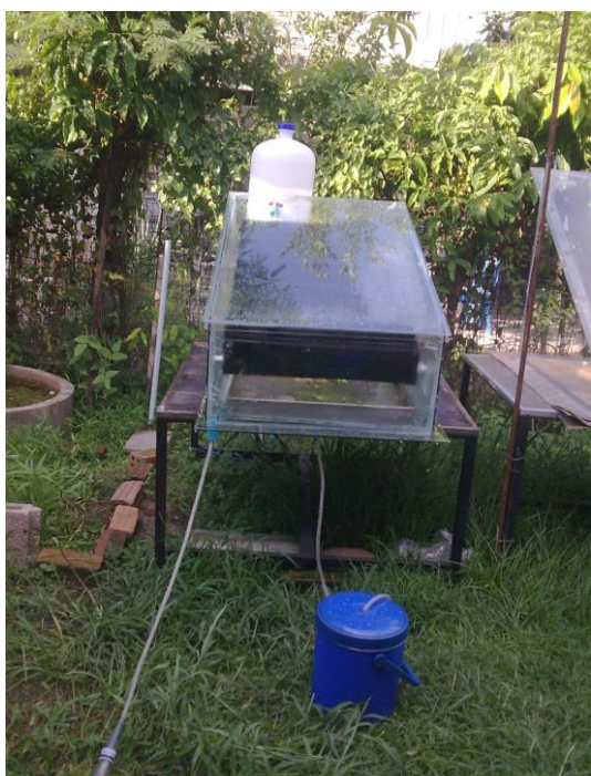
ภาพที่ ข-2 เครื่องทำอุ่นและน้ำกลั่นด้วยพลังงานแสงอาทิตย์แบบชั้นบันไดพื้นที่รองรับน้ำคิบ 0.89 ตารางเมตร
