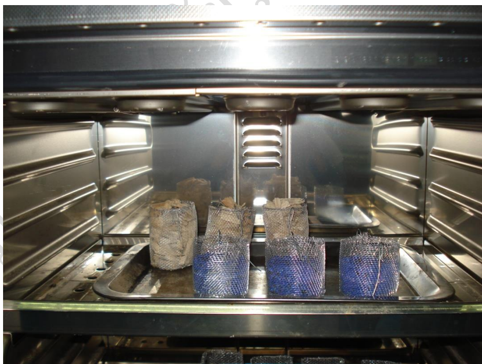
ภาพที่ ก-12 นำวัสดุชุบที่ทำกรทดลองแล้วอบที่อุณหภูมิ 105^{\circ}\text{C} เป็นเวลา 72 h เพื่อหาความชื้นสุดท้าย
