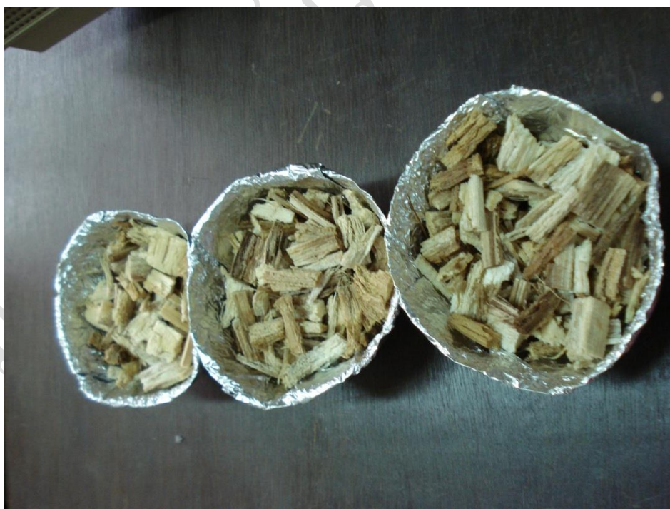
ภาพที่ ก-10 บรรจุวัสดุดูดซับในฟอยล์ เพื่ออบหาความชื้นเริ่มต้น ที่อุณหภูมิ 105^{\circ}\text{C} เป็นเวลา 72 h
