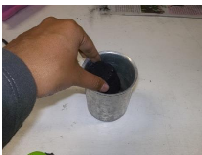
ภาพที่ 3.4 นำถ่านอัดแท่งใส่ในกระป๋องเคลอริมิเตอร์
