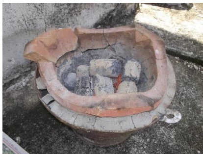
ภาพที่ 3.9 ทดสอบอัตราการเผาไหม้
