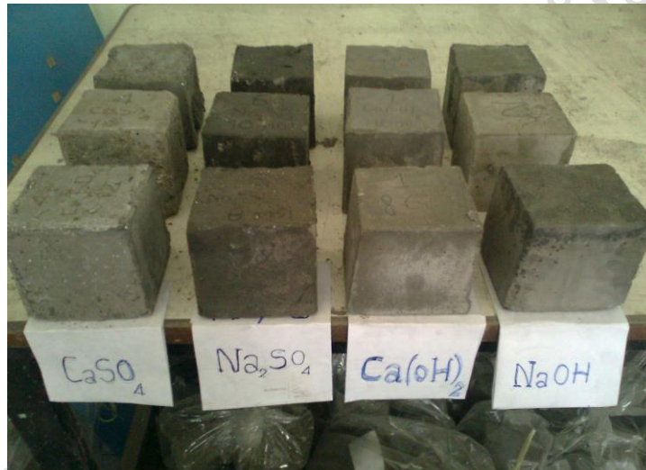
ภาพที่ 4.1 อิฐที่ผ่านการปรับปรุงเถ้าไม้ยางพาราด้วยสารเคมีกลุ่มอัลคาไลด์และกลุ่มซัลเฟต
