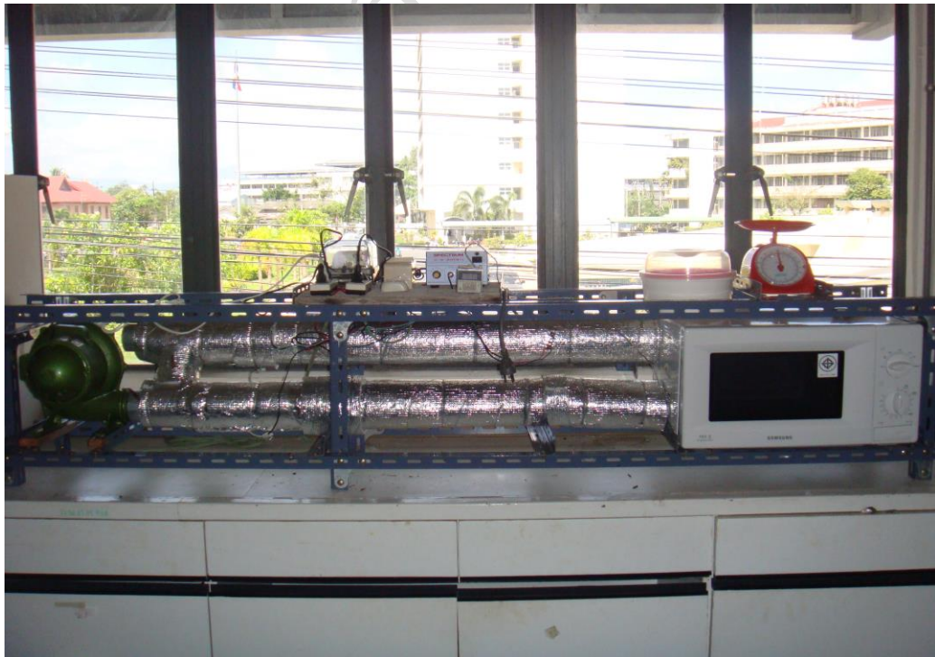
ภาพที่ ค - 2 เครื่องอบแห้งพลังงานความร้อนร่วม: YRU – HA/MW#1 (FR&E)
