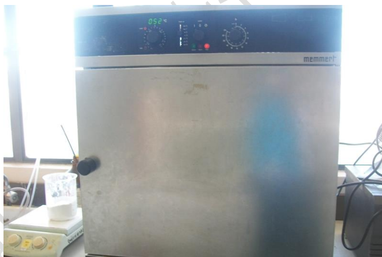
ภาพที่ ง-6 เครื่องอบ MEMMERT รุ่น UNB 400 230 V/50-60 HZ/1400 W
