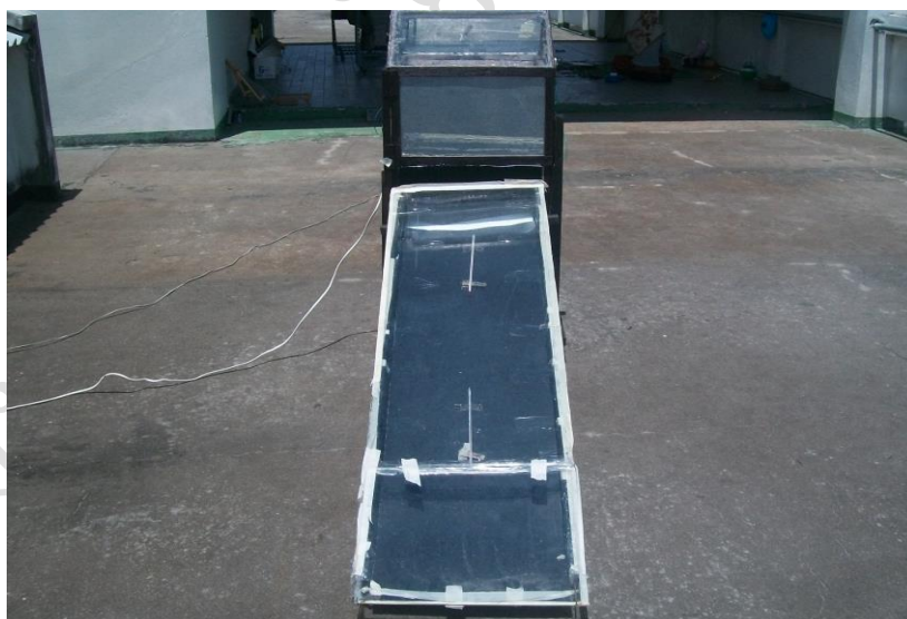
ภาพที่ ง-4 เครื่องอบแห้งพลังงานแสงอาทิตย์ร่วมรังสีอินฟราเรด :YRU – HA/IR DRYER (DS&E)
