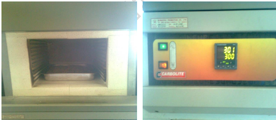
ภาพที่ 3.1 การเผาจี้เลื่อยและแกลบในเตาเผาที่อุณหภูมิ 300^{\circ}\text{C}
