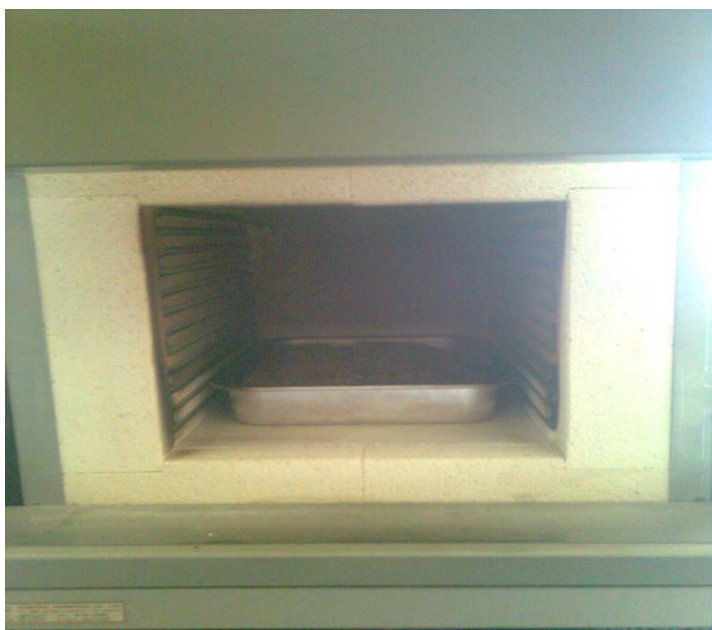
ภาพที่ ก-1 การเผาจีลีสและเกลบในเตาเผา
