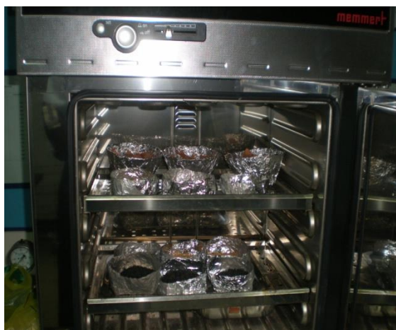
ภาพที่ 3.7 อุปกรณ์การดูดซับเพื่อหาความชื้นมาตรฐานแห้ง (% d.b.)
