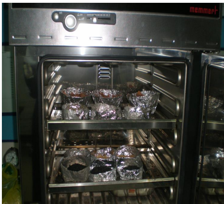
ภาพที่ ก-17 อบวัสดุในถ้วยฟอยล์เพื่อหาความชื้นสุดท้ายที่อุณหภูมิ 105^{\circ}\text{C} เป็นเวลา 72 h
