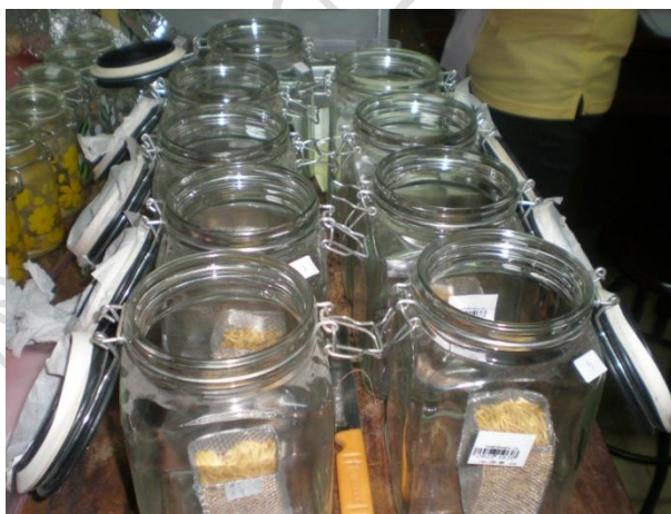
ภาพที่ 3.4 วัสดุที่ใช้ในการดูดซับมาใส่ในขวดโหลขวดละ 1 ตะแกรง ประมาณ 50 g
