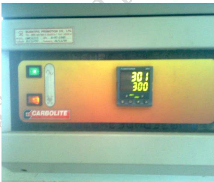
ภาพที่ ก-2 เตาเผา ยี่ห้อ CARBOLITE รุ่น OWF 1200
