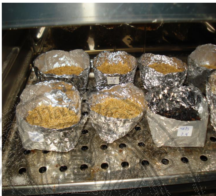
ภาพที่ ก-13 อบวัสดุดูดซับในถ้วยฟอยล์เพื่อหาความชื้นเริ่มต้นที่อุณหภูมิ 130^{\circ}\text{C} เป็นเวลา 5 h
