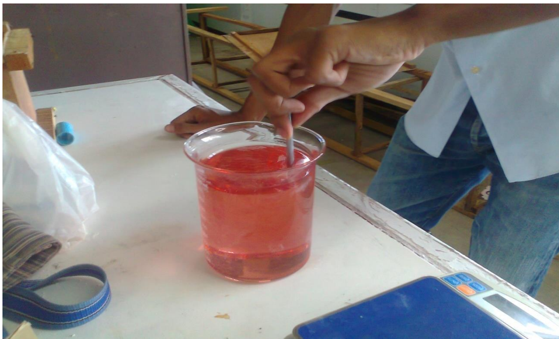
ภาพที่ ก-6 กวนเรซินกับน้ำยาฮาร์ดเนอร์ให้เข้ากัน
