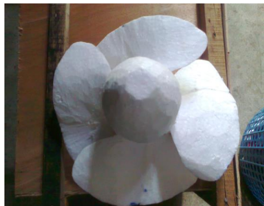
ภาพที่ 4.1 แบบใบพัดกังหันน้ำที่ทำจากโฟม
