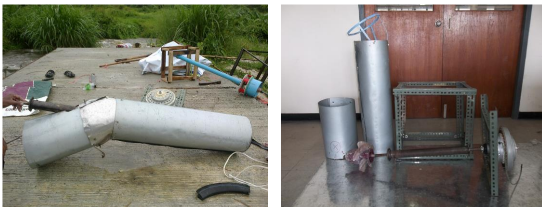
ภาพที่ 4.4 ท่อส่งน้ำที่ทำการม้วนเหล็กแผ่น
