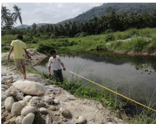
ภาพที่ 3.1 การวัดความกว้าง ความยาว และความลึกของสายน้ำ
