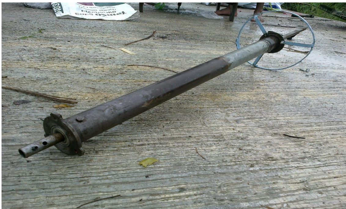
ภาพที่ ก-12 แกนทำจากเหล็กเชื่อมต่อระหว่างมอเตอร์กำเนิดไฟฟ้ากับชุดกังหันน้ำ
