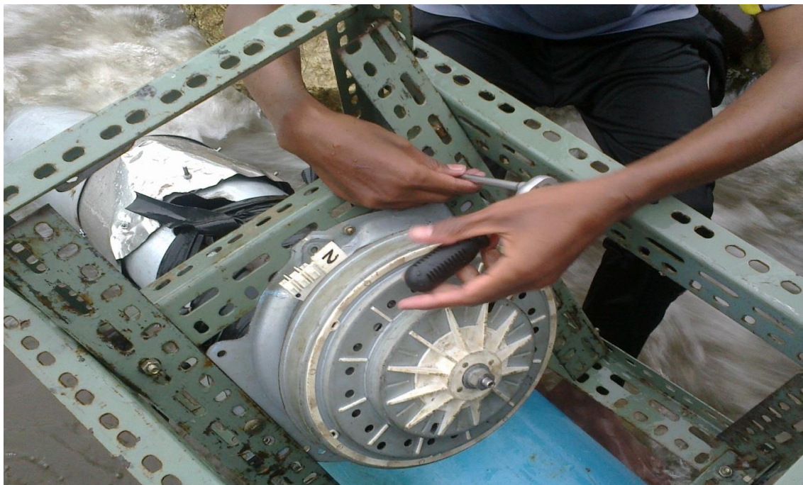
ภาพที่ ก-23 การติดตั้งมอเตอร์ให้เข้ากับแกนเหล็ก
