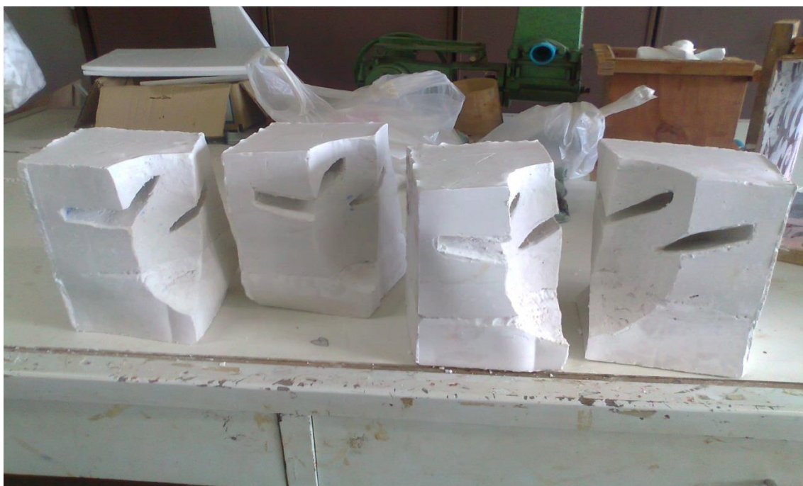
ภาพที่ ก-4 บล็อกกั้นน้ำเมื่อแกะโฟร์มออกจากปูนพลาสติก
