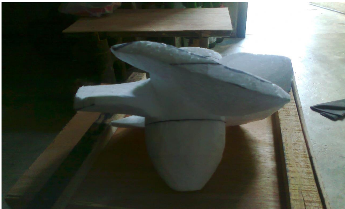
ภาพที่ ก-2 แบบกั้งหันน้ำที่แกะจากโฟรม
