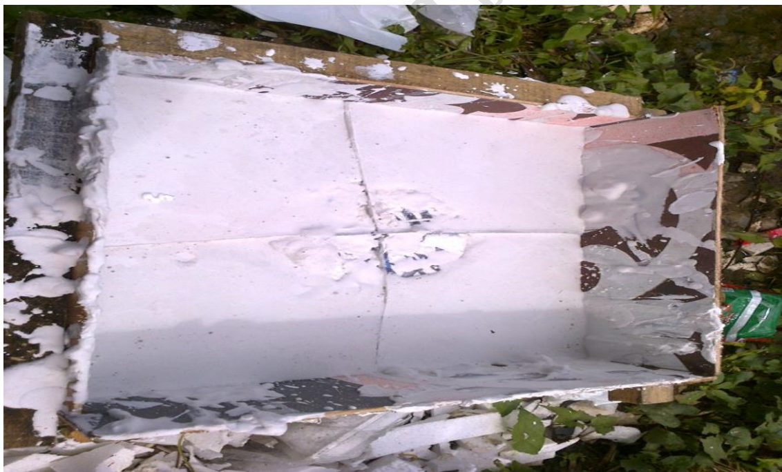
ภาพที่ ก-2 แบบกั้งหันน้ำที่แกะจากโฟรม
