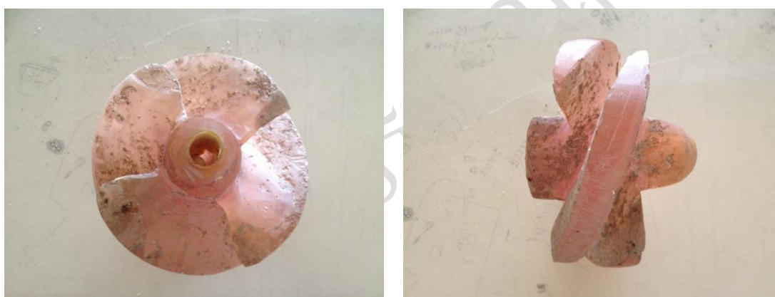
ภาพที่ 4.3 ใบพัดกังหันน้ำทีทำจากการหล่อเรซินในบล็อกปูนพลาสติกพร้อมใช้งาน
