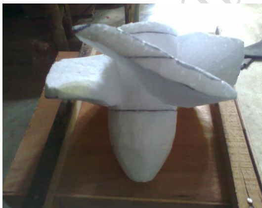
ภาพที่ 4.1 แบบใบพัดกังหันน้ำที่ทำจากโฟม
