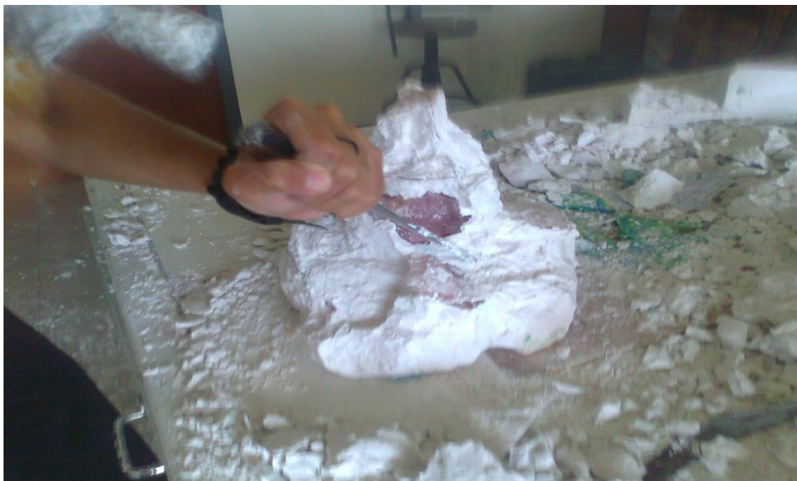
ภาพที่ ก-8 การแกะปูนพลาสติกออกจากเรซิน
