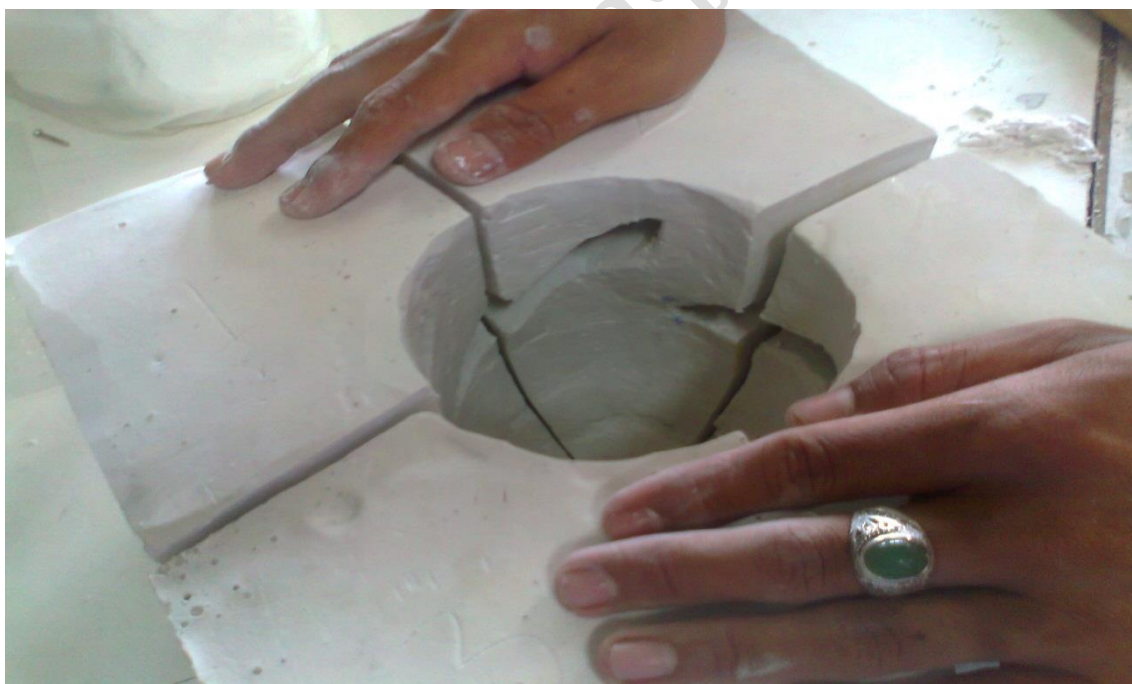
ภาพที่ ก-4 บล็อกกั้นน้ำเมื่อแกะโฟร์มออกจากปูนพลาสติก
