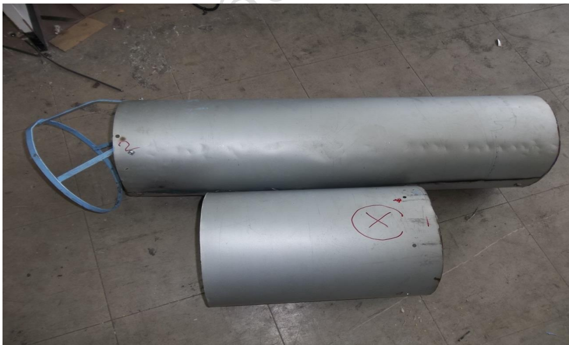
ภาพที่ ก-12 แกนทำจากเหล็กเชื่อมต่อระหว่างมอเตอร์กำเนิดไฟฟ้ากับชุดกังหันน้ำ
