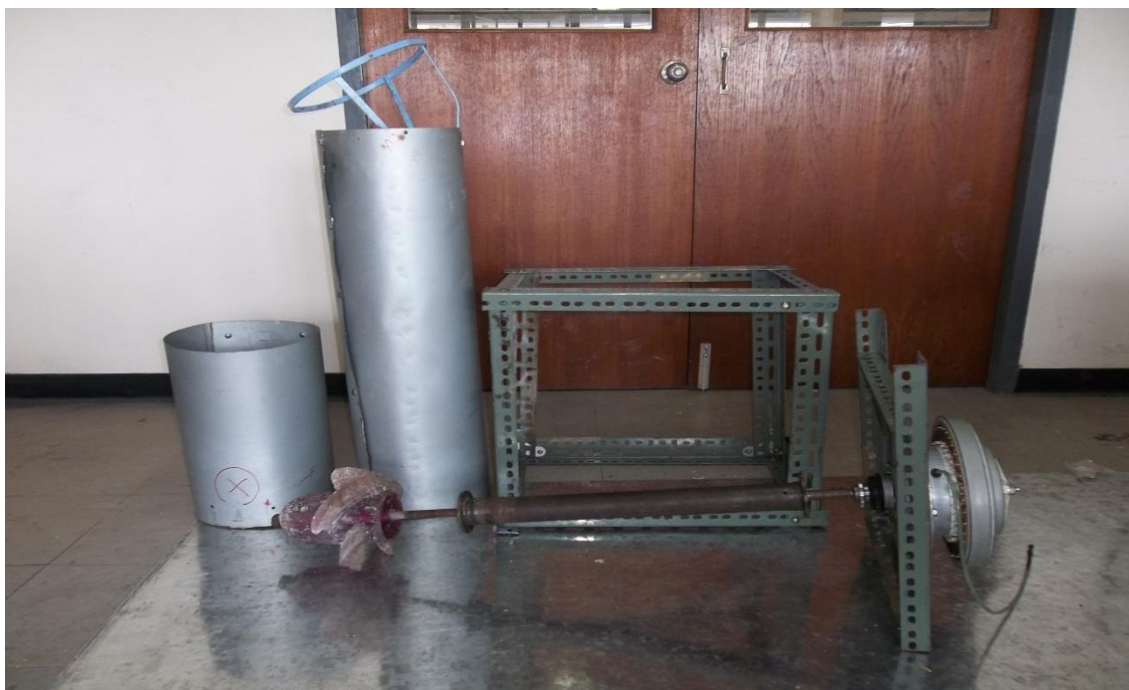
ภาพที่ ก-14 ส่วนประกอบของอุปกรณ์กำเนิดไฟฟ้าพลังงานน้ำอย่างง่ายที่ใช้ในการทดลอง
