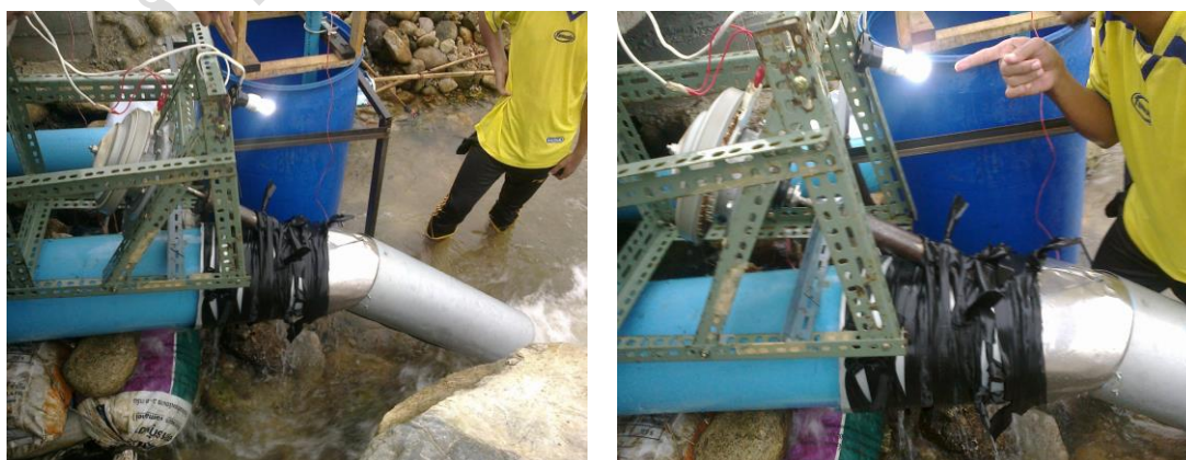
ภาพที่ 4.7 การทดสอบระบบผลิตไฟฟ้าพลังงานน้ำขนาดเล็กอย่างง่าย
