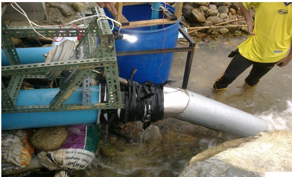
ภาพที่ ก-25 การทดลองปล่อยน้ำให้ชุดผลิตไฟฟ้าพลังงานน้ำอย่างง่ายทำงาน
