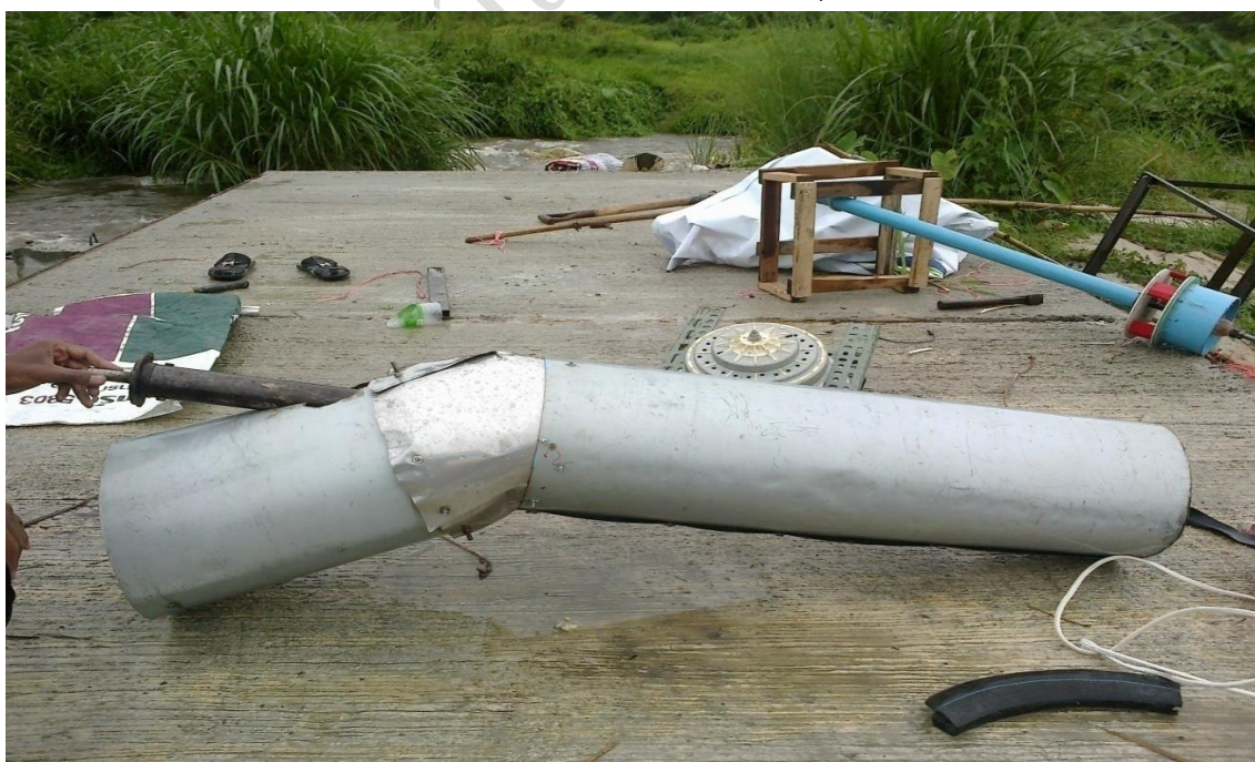
ภาพที่ ก-16 การวางท่อพีวีซี (PVC) ขนาด 10 นิ้ว เพื่อส่งน้ำเข้าสู่ชุดกำเนิดไฟฟ้าพลังงานน้ำอย่างง่าย
