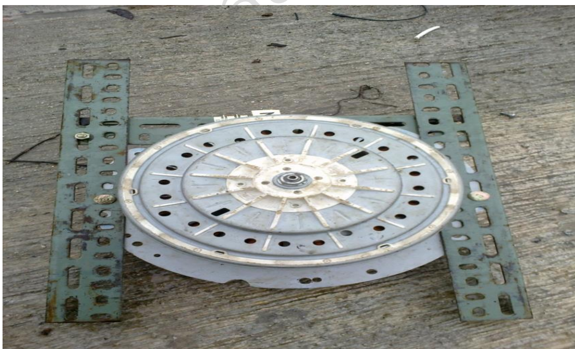
ภาพที่ ก-11 มอเตอร์เครื่องชักผ้าที่ใช้ในการทดลองกำเนิดไฟฟ้ากระแสสลับ
