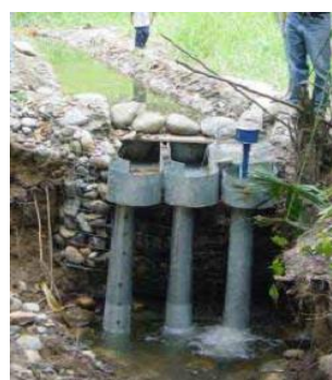
ภาพที่ 2.5 กังหันน้ำแบบคอยาวขนาด 200 W สำหรับครัวเรือนที่ติดตั้งในประเทศเอกวาดอร์ (ที่มา : John et al., 2005)
