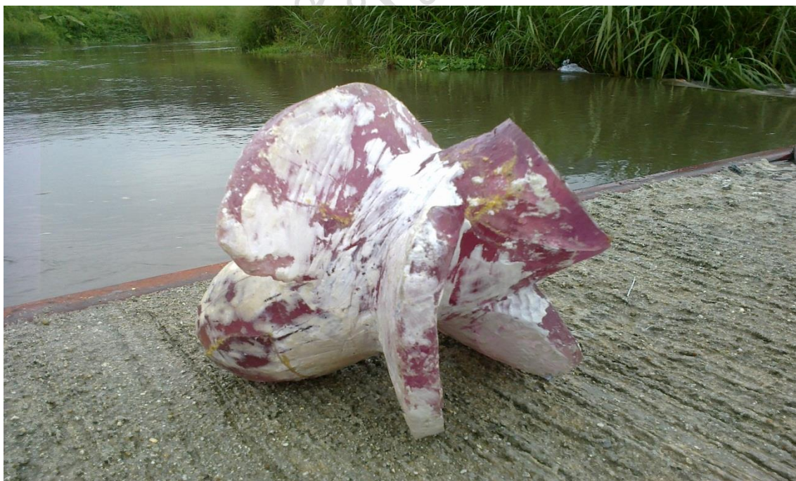
ภาพที่ ก-9 กังหันน้ำขนาดเส้นผ่านศูนย์กลางแกน 4 นิ้ว ที่แกะออกจากบล็อก
