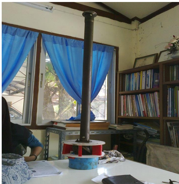
ภาพที่ 3.3 การนำช่องใบพัดมายึดติดกับแกนเหล็ก (ด้านบนสุดจะนำไปยึดกับมอเตอร์เครื่องชักผ้า)
