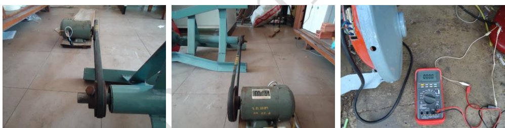
ภาพที่ 4.2 การทดสอบชุดกำเนิดไฟฟ้าโดยใช้มอเตอร์ 3 เฟส
