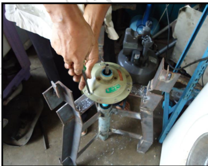
ภาพที่ ข-4 การติดตั้งเครื่องกำเนิดไฟฟ้า
