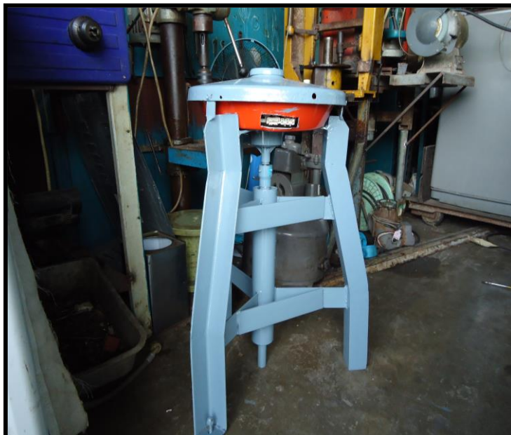
ภาพที่ ข-5 เครื่องกำเนิดไฟฟ้าเสร็จจากการประกอบ
