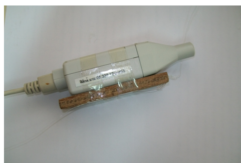
ภาพที่ 3.2 ออกแบบที่ติดหัววัดภายในท่อที่สามารถเลื่อนไปมาได้
