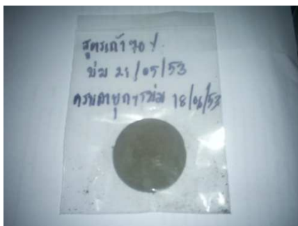
ภาพที่ 4.5 อิฐที่มีส่วนผสมของเถ้าไม้ยางพาราสำหรับหาค่าสัมประสิทธิ์การดูดซับเสียง
