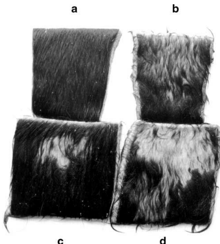
รูป 2.2 กิจกรรมการถอนขนของหนังวัวโดยเคราตินเนส Kr6 a, ชุดควบคุมใช้เคราตินเนสที่ผ่านความร้อนมา, b ชุดทดสอบใช้เคราตินเนส, c และ d ชุดใช้เคราตินเนสและตามด้วยการถูออก
