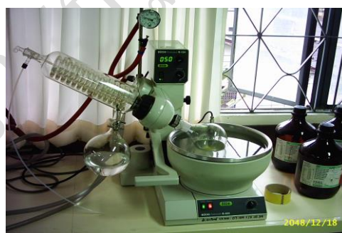
ระเหยตัวทำละลายโดย Rotary Evaporator
